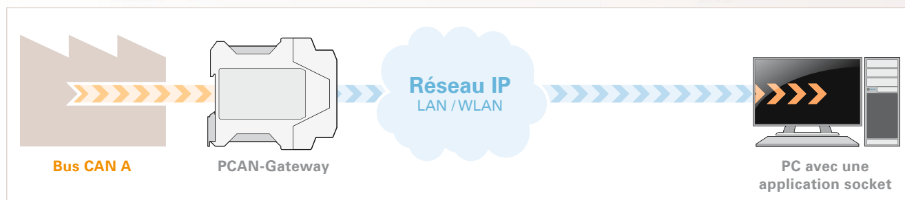
Exemple 3 : Connexion via une socket applicative
