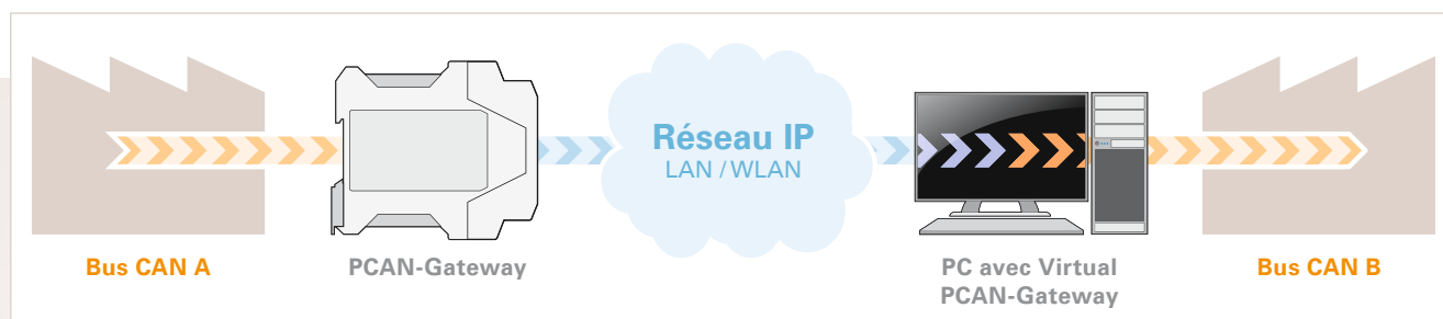
Exemple 4 : Connexion à l'aide du logiciel Virtual PCAN-Gateway
